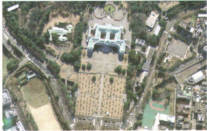
Links: Stadtzentrum von Tokio, aufgenommen aus einer Flughöhe von 2900 Meter über Grund von PASCO am 28. Januar 2002 mit dem Leica Geosystems Flugaufnahme-Digitalsensor ADS40 in sieben unterschiedlichen Bändern für die dreidimensionale digitale photogrammetrische Auswertung, Fernerkundung und Erstellung eines Geographischen Informations-Systems (GIS). Die Bodenpixelgröße in dieser Datei beträgt 0,3 m. Bildausschnitt rechts: Das Dateidetail zeigt das Staatsgästehaus.
