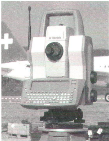
5600: der einzige Tachymeter mit aktiver Zielverfolgung für problemlosen Ein-Personenbetrieb (mit Zeiss- oder Geodimeterbedienung).
