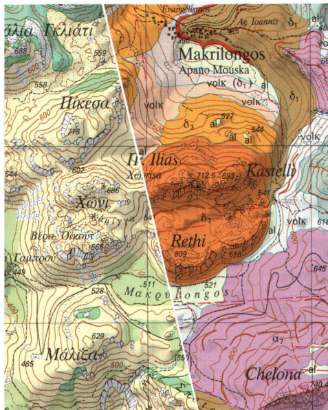
Abb. 1: Ausschnitt aus der digital erstellten topographischen (links) und der geologischen (rechts) Karte der Halbinsel Methana Methana/ Griechenland. Die gleiche topographische Basiskarte wird mit verschiedenen Themen (Landnutzung, Geologie) überlagert (Hurni 1995).
