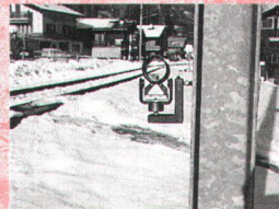
Gleisversicherung Vérification de l'axe d'une voie ferrée
