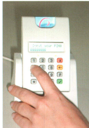
Abb. 1: Für die «digitale Signatur» wird ein Kartenleser an den Rechner angeschlossen, der die persönliche Signatur (Public Key Service Karte) zusammen mit einer PIN ausgewertet und verifiziert.
