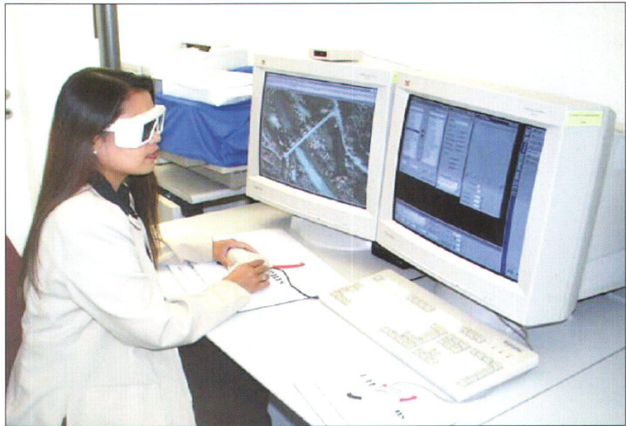
Abb. 4: Digitale Photogrammetrische Workstation LEICA DPW der Landestopographie. Digitales Modell mit teilweise automatischer Auswertung unter ausschliesslicher Verwendung von digitalen Bilddaten.
