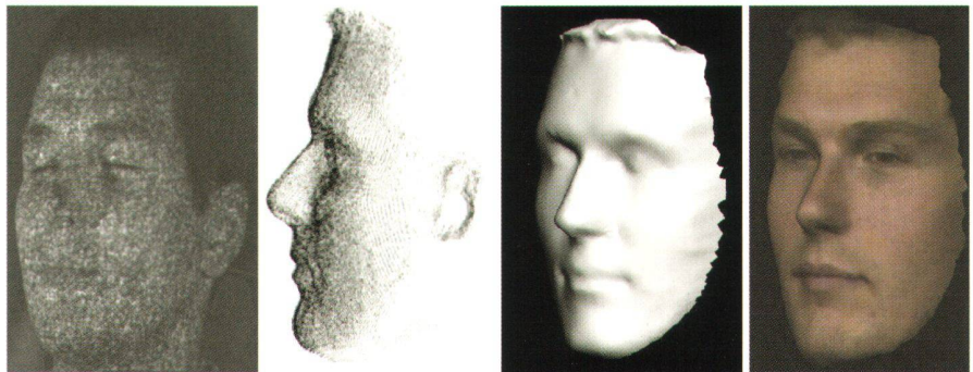
Abb. 1: Automatische Gesichtsvermessung. Von links: Texturprojektion, 3D-Punkthaufen, schattiertes 3D-Modell, photorealistisches texturiertes 3D-Modell.
