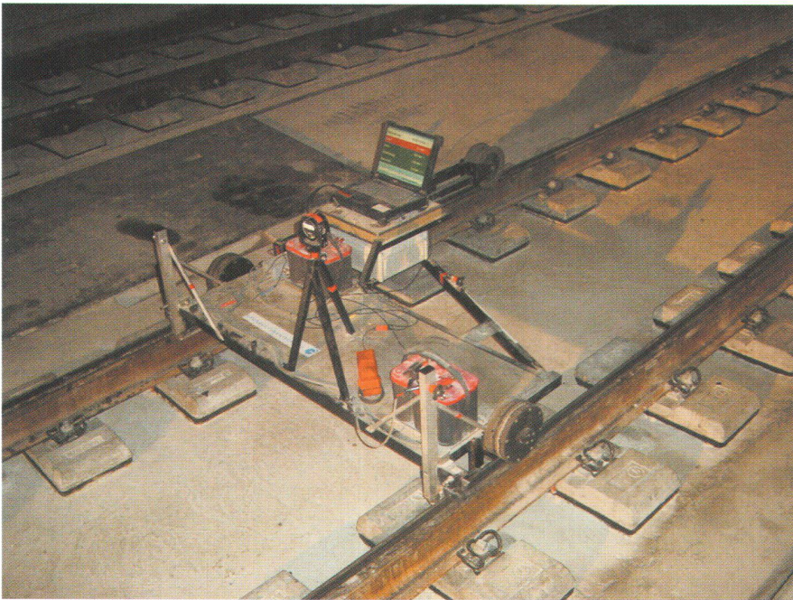
Abb. 5: Der Burgdorfer Gleismesswagen.
