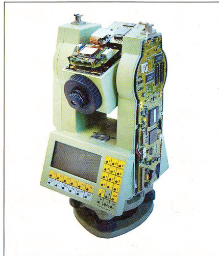
Abb. 4: Die modernsten Tachymeter unserer Zeit folgen dem Grundprinzip von Heinrich Wild. Allerdings integrieren sie heute die Laserdistanzmessung, Mikroelektronik und Software mit zahlreichen Mess- und Berechnungsfunktionen auf Tastendruck.
