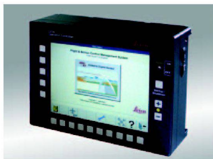
Abb. 9: Klein-Bildschirm Flugführungs-Anzeige für den Piloten, OC50 für FCMS v2.0.
