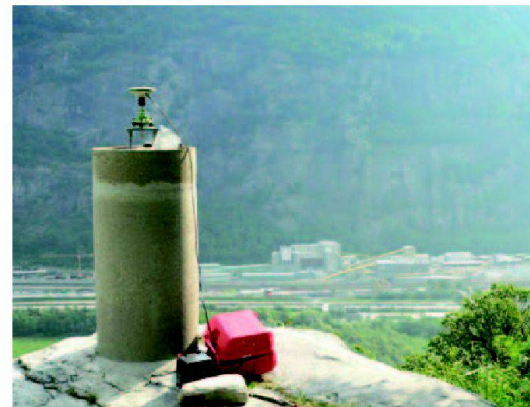
Abb.1: Pfeiler Grundlagennetz in Bodio.
