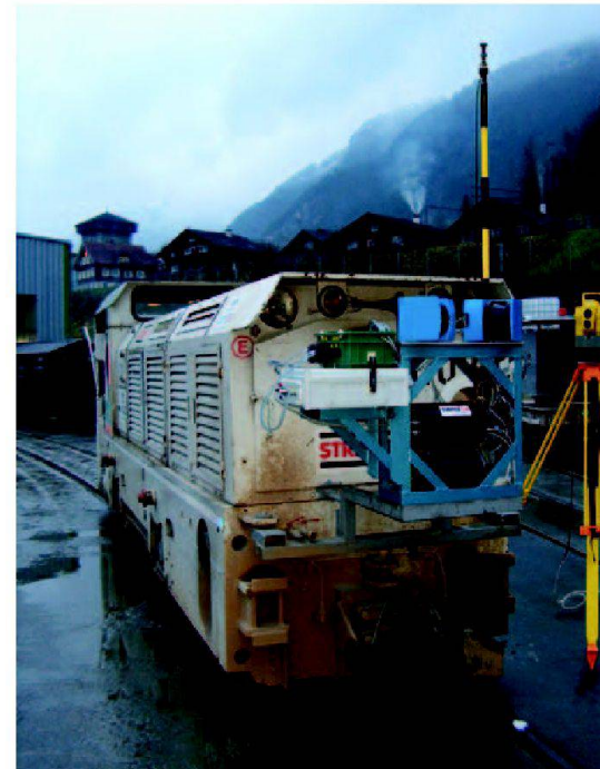
Abb. 1: Scan-Ausrüstung auf Stollenlok montiert.
