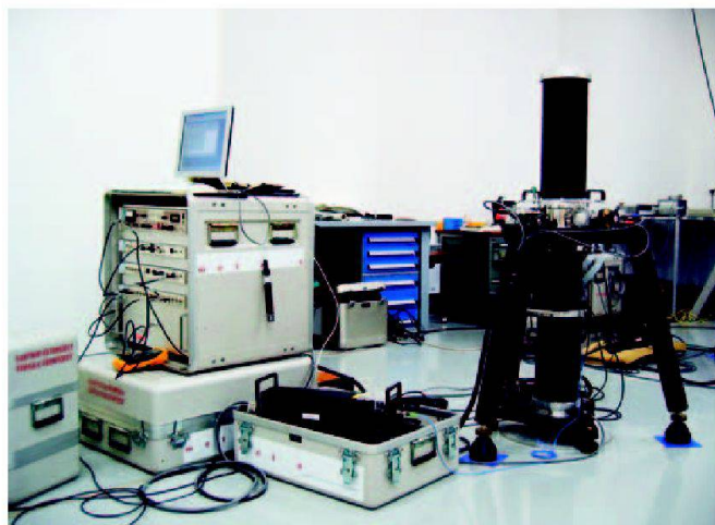
Fig. 2: Le gravimètre absolu de type FG5 de METAS.
