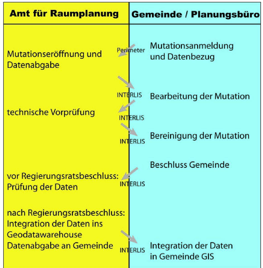
Abb. 1: Ablauf und Datenfluss für eine Zonenplanmutation.
