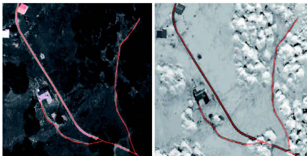
Fig. 4: Zones traitées à l'aide d'Easytrace, l'information vectorielle est en rouge (à g. RGB, à d. prétraitée NDRI).
