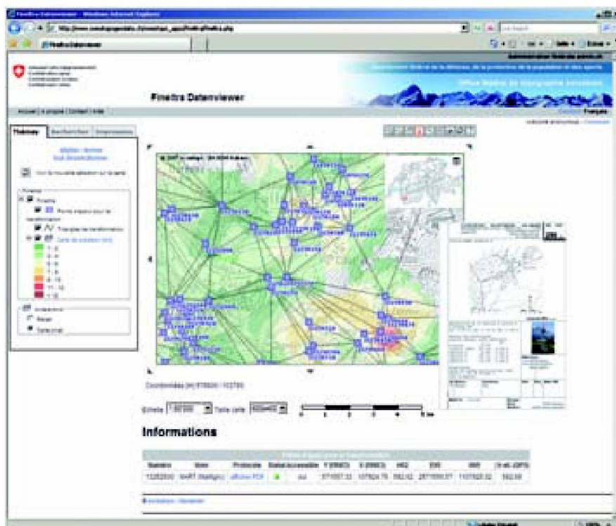
Fig. 6b: Visualiseur de données FINELTRA avec le maillage des triangles, les points d'appui ainsi que la précision empirique de transformation dans la région de Martigny. On peut accéder directement aux fiches signalétiques par l'intermédiaire du service de données sur les points fixes.
