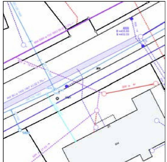
Werkplan mit Wasser und Abwasser.
