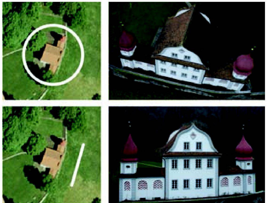
Abb. 2: Links: Flugpfad: Kreisförmig um das Gebäude (oben) und frontal zur Fassade (unten), Orthophoto: www.gis.ow.ch , 2008; rechts: Schrägaufnahme vom kreisförmigen Flugpfad (oben) und Fassade des Schützenhauses (unten).
