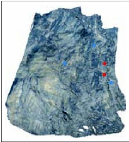
Abb. 5: Ein Teil der modellierten Felswand mit den zur Beobachtung zur Verfügung stehenden Prismen.
