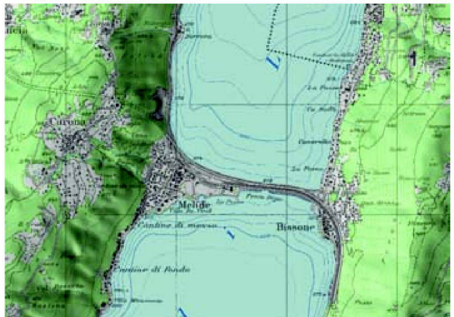
Abb. 2: Melide. Reliefschattierung automatisch aus dem DHM25 berechnet. Darstellung in der Landeskarte 1:25 000. Daten Bundesamt für Landestopografie. Verarbeitung mit RAVIS (M. Zanini).
