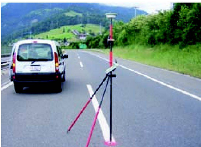
Abb. 4: Passpunktmessung mittels GPS.
