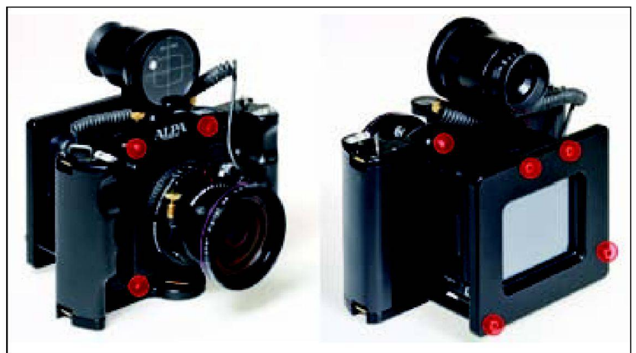
Abb. 6: Alpa 12 Metric mit 35-mm-Rodenstock-Objektiv und Leaf Aptus 75 Digitalrückteil. An den rot markierten Stellen wurde die Kamera mit Schrauben stabilisiert. Das Rückteil wird von hinten an den Kamerakörper angedrückt.
