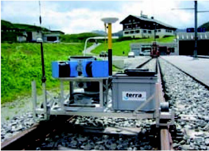
Abb. 6: Gleismesswagen Swisstrolley (terra) und RACER (UniBw).
