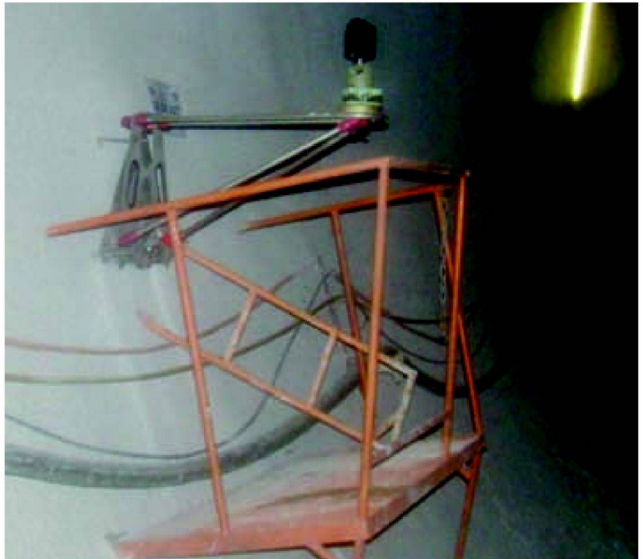
Abb. 7: Messkonsole mit Standbühne.
