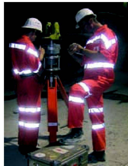
Abb. 5: Kreiselmessungen mit dem Gyromat 2000, Version UniBwM (Drahtlose Steuerung, Datenübertragung und Auswertung über PDA).
