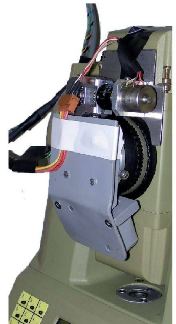
Fig. 7: TCA 2003 sur lequel est monté la caméra et la motorisation de mise au point.
