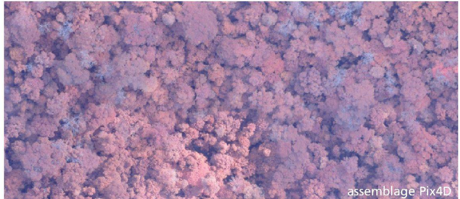
Fig. 4: Orthomosaïque en forêt dense (GSD: 15 cm).
