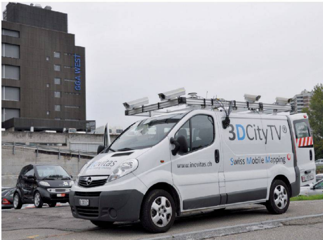
Abb. 2: Mobile Mapping Fahrzeug von iNovitas (Quelle: GeoZ).
