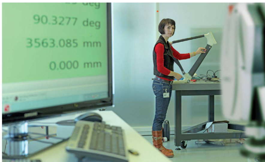
Abb. 1: Tracker Pilot DRO (Data Read Out) bei der Messung mit 1.5" RRR (Red Ring Reflector) und Leica Absolute Tracker AT401 (Foto: Hexagon Metrology).
