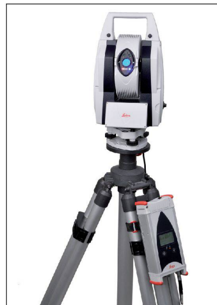
Abb. 2: Leica Absolute Tracker AT401 mit Controller und Stativ (Foto: Hexagon Metrology).
