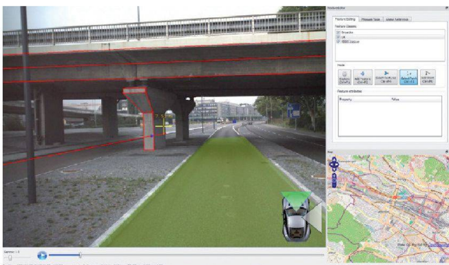
Abb. 9: Autobahnbrücke aus Perspektive MMS.
