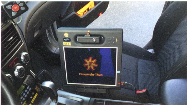
Motion F5te Tablet PC inkl. Mobile Dock im Einsatzleiterfahrzeug. Tablette Motion F5te incluant la station Mobile Dock dans le véhicule du chef d'intervention.
