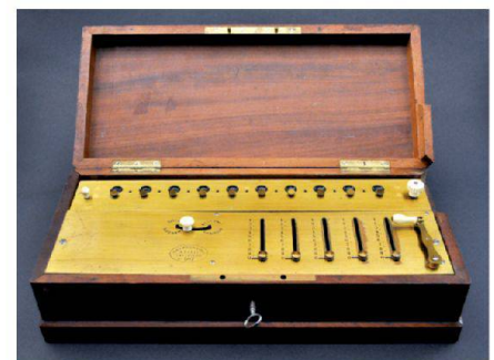
Abb. 1: Thomas-Arithmometer aus Paris. Ein Meilenstein in der Geschichte der Rechentechnik: Das am 28. Januar 2014 in der Kulturgütersammlung der ETH Zürich (wieder) gefundene 150-jährige Thomas-Arithmometer, eine Vierspezies-Staffelwalzenmaschine aus Messing und Holz. © Herbert Spühler, Stallikon.
