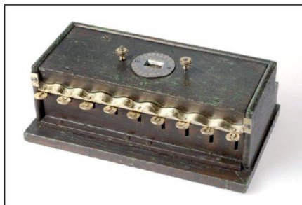
Abb. 3 und 4: Diese Schwilgué-Tastenaddiermaschine befindet sich im Historischen Museum in Strassburg. © Strassburger Museen 2014, Mathieu Bertola.
