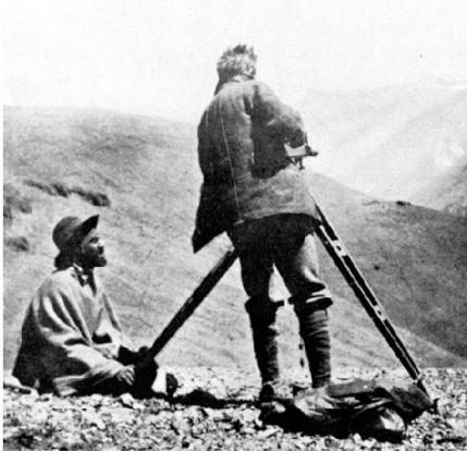
Abb. 2: Robert Helbling am 24. Februar 1909 bei ersten Vermessungsarbeiten auf dem Cerro Rotondo. Der chilenische Maultiertreiber «el Negrito» hilft bei starkem Wind den Phototheodoliten zu stabilisieren (aus: Larden 1974).
