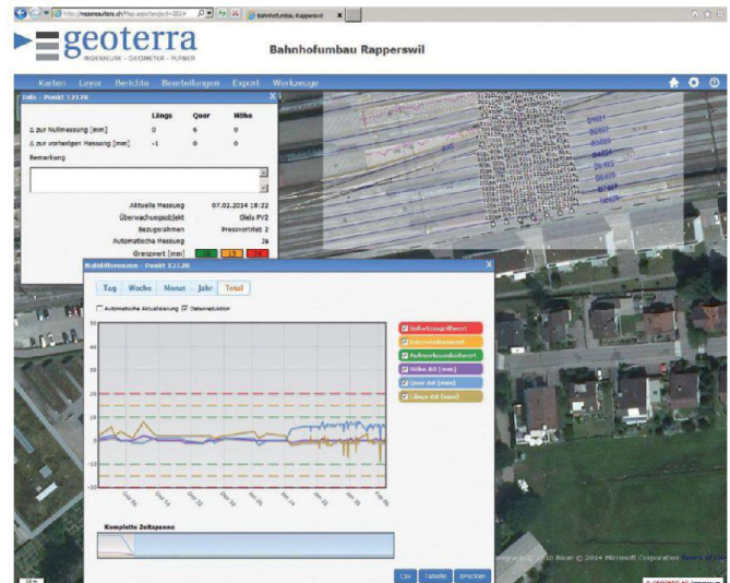
Abb. 1: Monitoring mit dem Geoterra Web-Portal.
