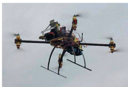
Abb. 1: Oktokopter mit Ausrüstung (Durchmesser: 80 cm).
