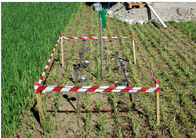
Abb. 7: Tensiometermessfeld mit je 3 Tensio- metern im Ober- und Unterboden sowie einem Regenmesser.
