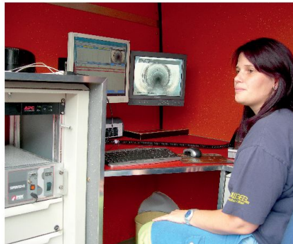
Abb. 6: Demo Kanalfernsehen (Bild: W. Wehrli).
