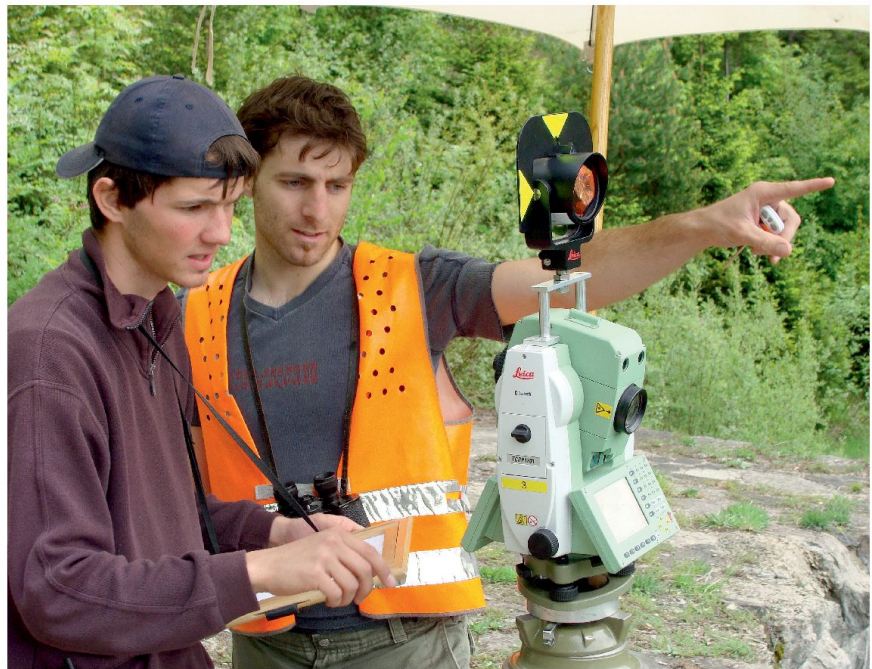
Abb. 5: Studierende der FHNW und FH Dresden im Messeinsatz mit Spezialadapter auf TPS.
