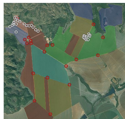
Fig. 4: Vue d'ensemble des relevés de terrain: les couleurs représentent la carte de répartition des géotypes, les cercles blancs représentent les mesures sur feuilles et les cercles rouges les mesures au sol.
