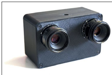
Fig. 3: Caméra hyperspectrale OXI de Gamaya.
