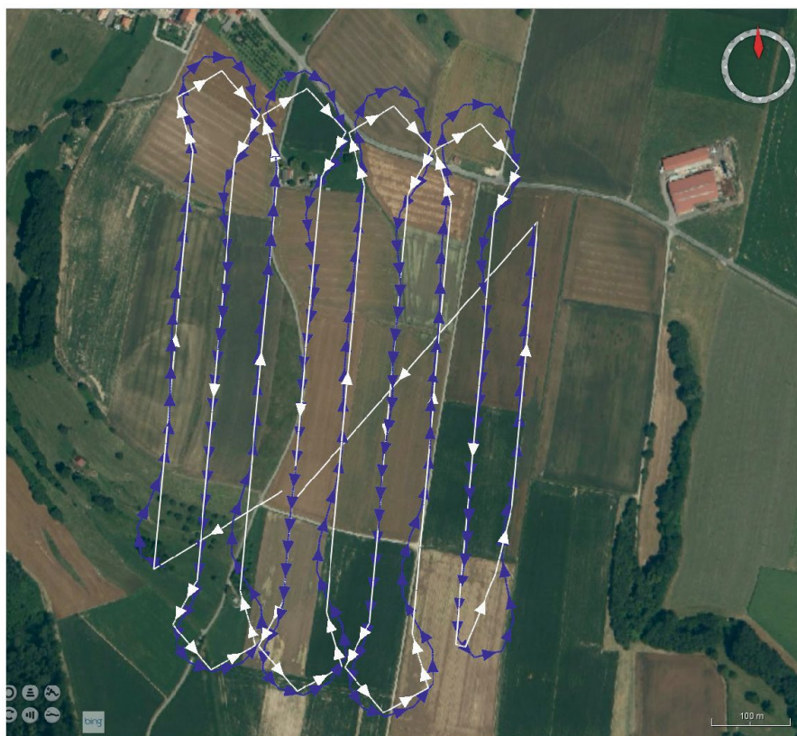
Fig. 5: Vue de haut d'une trajectoire réalisée en bleu par rapport à la trajectoire planifiée en blanc.
