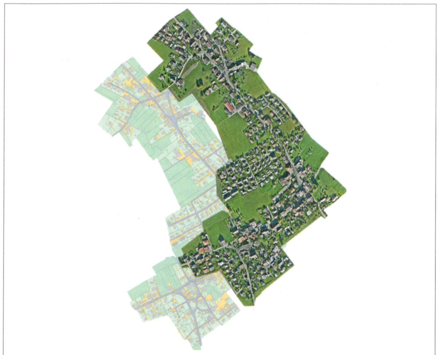
Fig. 1: Orthomosaïque produite par drone et le plan du registre foncier mis à jour. Abb. 1: Orthophotomosaik aus Drohnenaufnahmen und nachgeführtem Grundbuchplan.
