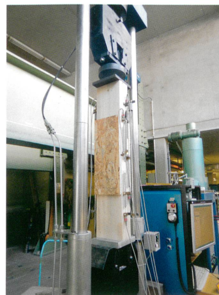
Fig. 2: Essais de charge cyclique sur un assemblage dans le laboratoire de structures de la HEIG-VD.
