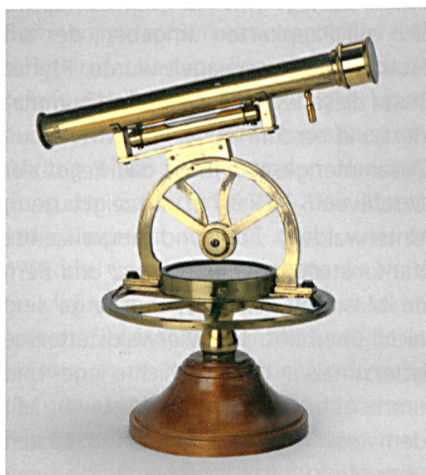
Abb. 2: Theodolit um 1820 der Firma W&S. Jones, London. Pfyffer erarbeitete seine Daten mit Basismessung und Triangulation. Er verwendete die besten damals in Europa erhältlichen Messinstrumente. Sammlung Mathematisch-Physikalischer Salon Dresden.
