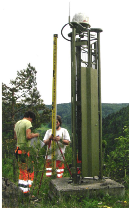
Abb. 5: GNSS-Referenzstation MTTI – eingebunden ins AGNES-Netz CH.
