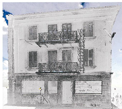
Fassadenaufnahme mit Laserscanning Punktwolke.
