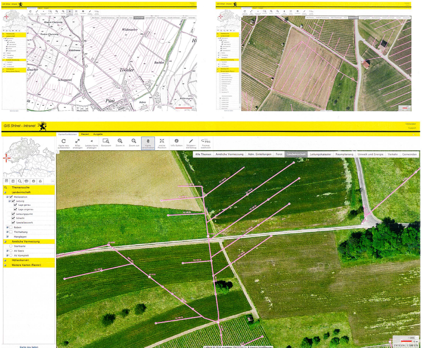
Abb. 3–5: GIS SH: Meliorationsleitungen.
