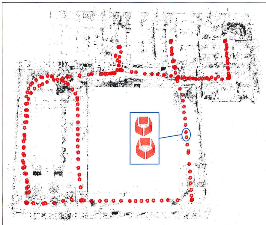
Abb. 2: Untersuchungsgebiet im alten FHNW-Hauptgebäude in Muttenz mit georeferenzierten Mobile-Mapping-Bildern (rot) und 3D-Verknüpfungspunkten (schwarz), resultierend aus COLMAP, einer modifizierten Bündelblockausgleichungspipeline (Cavegn et al., 2018).
