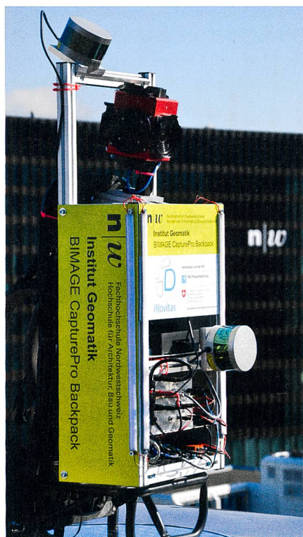
Abb. 1: Portables bildbasiertes 3D-Erfassungssystem für Innenräume als Prototyp (Blaser et al., 2018).
