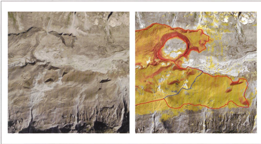
Abb. 5: Schuttbedeckte Gletscherzunge Unteraargletscher: Links Orthophoto mit schwierig abzugrenzender Eismasse. Rechts: Orthophoto mit Höhendifferenz aus swissALTI 3D und Interpretationsvarianten der Gletscherabgrenzungen (blaue und rote Linien).
