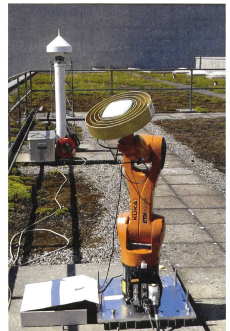
Fig.3: Robot industriel KUKA à six axes sur le toit de l'Institut de géodésie et de photogrammétrie de l'ETH Zurich au Höggerberg. L'antenne de référence est visible à l'arrière-plan.
