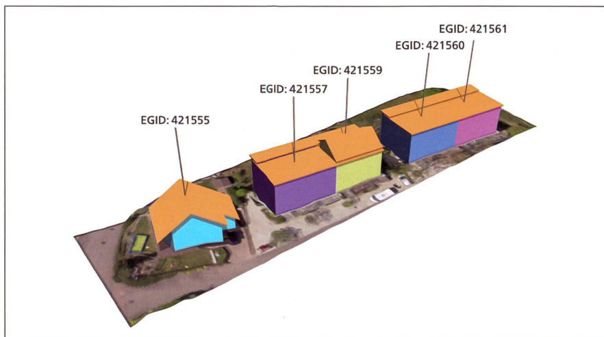
Fig. 6: Développement prévu pour swissBUILDINGS3D : une partition par identificateur fédéral de bâtiment (EGID).
